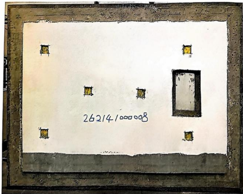
图 4. 耐候性试样试验后拉伸粘结强度试验照片
